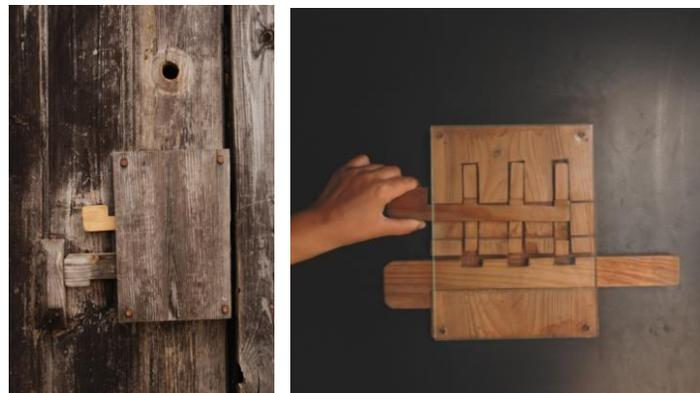
**Figura 23:** Fechadura e maqueta do respetivo sistema interno de funcionamento (NMS Figueira da Foz)
