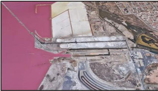
**Figura 19:** Instalaciones salineras ya en desuso: diques de sillería, antigua garbera y balsas de fábrica químicas (Imagen: Google)
